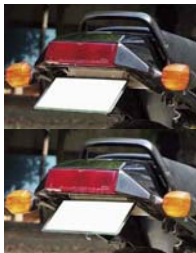
●写真上がナンバープレートをもっとも手前・下に、下がもっとも奥上にした状態。このように比較的自由度の高い取り付けが可能となっているのも同製品の特徴だ
